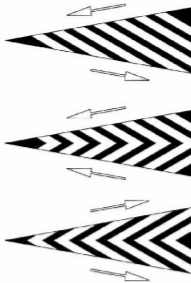
Spații interzise circulației
